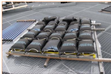
Abb. 3 Links: Belastungsanlage mit pneumatischen Zylindern
