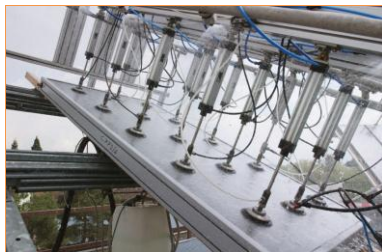
Abb. 3 Links: Belastungsanlage mit pneumatischen Zylindern
