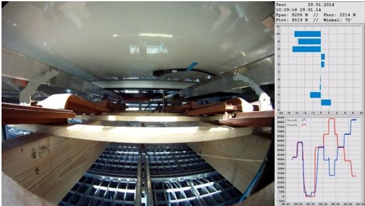
Abb. 11: Beispiel einer Prüfung eines PV Moduls auf einem simulierten Ziegeldach. Screenshot des Resultatfilmes. Die Kamera ist unter den Modulen zwischen den Ziegeln platziert. Auf der rechten Seite sind die aktuellen Messdaten wie Auslenkung der Distanzsensoren, einwirkende Kräfte, simulierte Dachneigung, u.s.w. aufgezeichnet. Auf dem Bild wird gerade eine extreme Dachneigung von 75^\circ simuliert.
