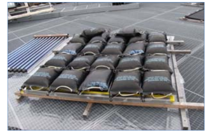
Abb. 3 Belastungstestanlage mit Wasser-/Sandsäcken. Günstig und einfach.
