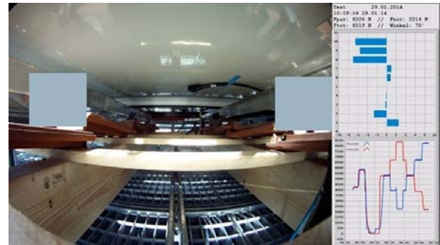
Abb.9 Weitwinkelvideokameras werden an „interessanten“ Stellen platziert und ermöglichen es den Schadenverlauf mitzuverfolgen. Gleichzeitig werden alle Kräfte und Auslenkung der Distanzsensoren angezeigt. Damit ist eine eingehende Analyse der Schwachstellen möglich. Im gezeigten Beispiel sind „vertrauliche“ Bereiche ausgegraut.
