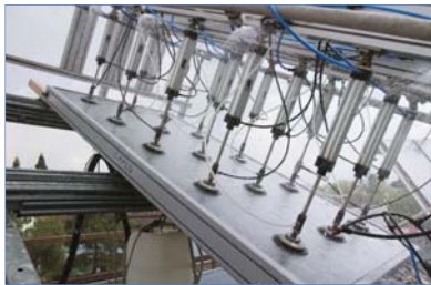
Abb. 1 Belastungstestanlage mit pneumatischen Zylindern. Technisch aufwändig.
