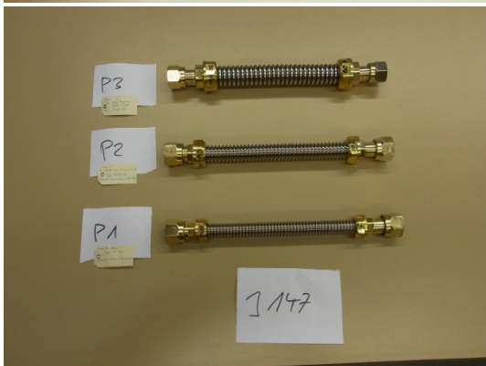
Abb. 4: (Vor dem Einbau) Drei verschiedene Grössen wurden geprüft mit drei verschiedenen Marken von Edelstahlwellrohren. P1: DN16 (Rattay HR I/S-W) P2: DN20 (Solar Kurt Birnbreier, MF015 500) P3: DN25 (Radio Frequency Systems, PW025-AFL)
