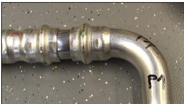
Abb. 4 (Vor dem Test) Detailansicht Pressverbindungen Edelstahlrohr 1.4520 x Fitting Edelstahl 1.4401
