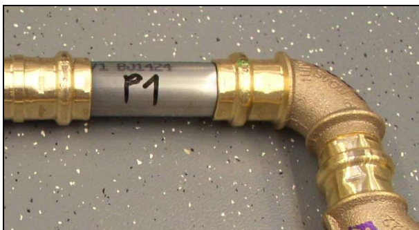
Abb. 5 (Vor dem Test) Detailansicht Pressverbindungen Edelstahlrohr 1.4521 x Fitting Rotguss
