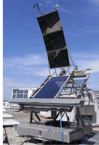
Abb. 3: Wkl-Messung des 3. Testmusters am TestLab Solar Thermal des ISE
