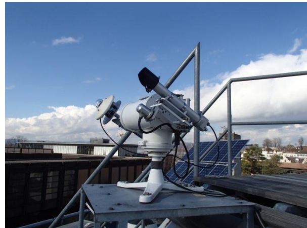
Abbildung 2: Pyrheliometer auf Meteotracker zur Direktstrahlungsmessung
