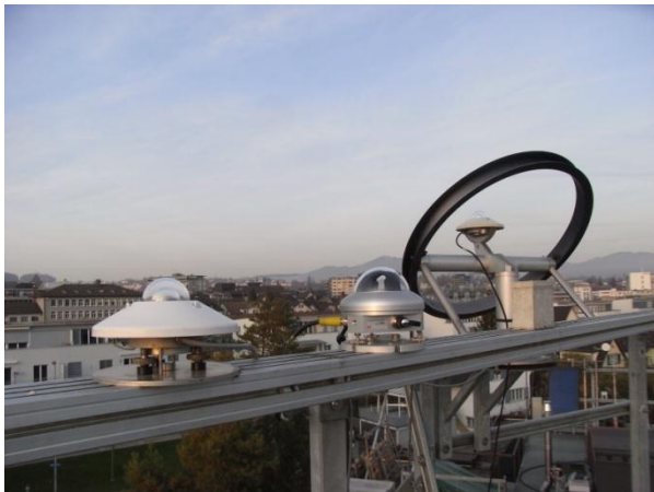
Abbildung 1: Pyranometer (links), SPN1 (Mitte) und Pyranometer mit Schattenring zur Diffusstrahlungsmessung (rechts)
