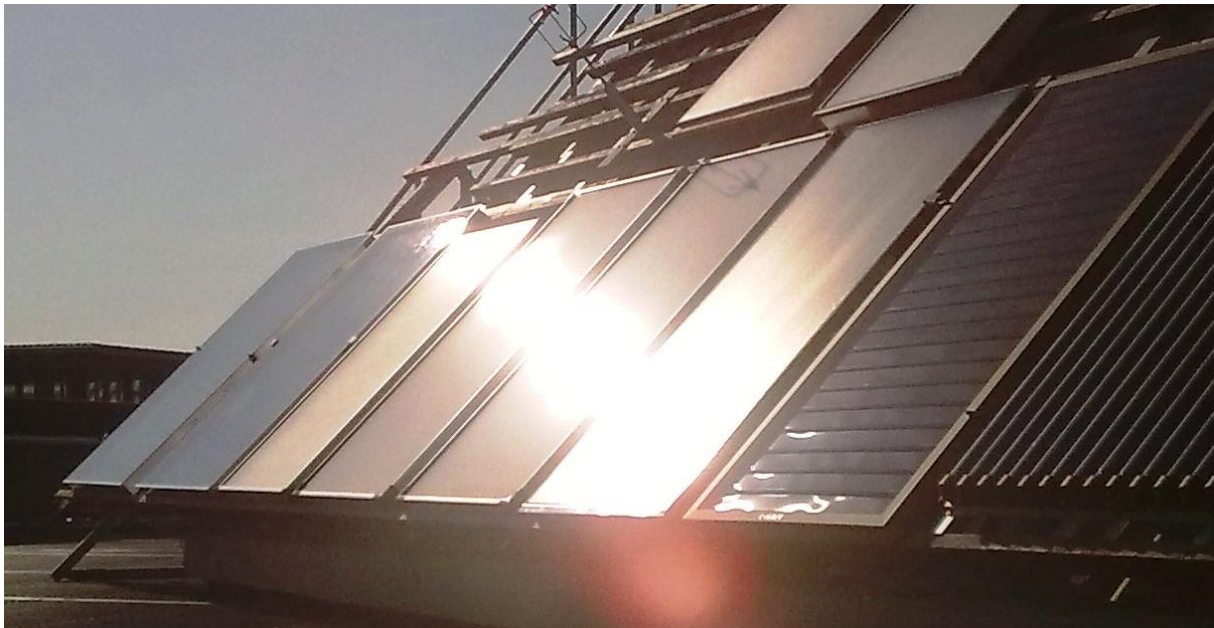
Abb. 3: Blendung an verschiedenen Flachkollektortypen auf dem Versuchsdach des Institutes für Solartechnik SPF. Es ist deutlich sichtbar, dass der Reflex auf dem Kollektor vorne rechts deutlich grösser erscheint als bei den übrigen Kollektoren. Dies weil die Abdeckung des Kollektors eine stark strukturierte Oberfläche hat.
